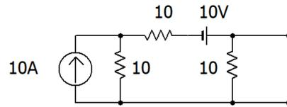
8. 次の回路において、真中の  $R[\Omega]$  に流れる電流を求めなさい。 $R[\Omega]$  で消費される電力が最大ときの  $R$  の値を求めよ。
