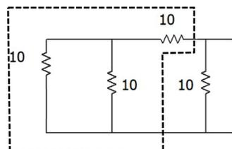
ここで点線の部分の抵抗は  $10\Omega$  と  $10\Omega$  二本並列の直列であると考え。暗算で  $15\Omega$  がでる。つまり、二端子間の抵抗、すなわち内部抵抗は、 $15\Omega$  と  $10\Omega$  の並列である。
