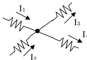
図のように2つの電流が接点（図では黒点）に入り、2つの電流が接点から出ていく場合、入ってくる電流を+とし、出ていく電流をマイナスとして足し合わせるとゼロになる。つまり、
