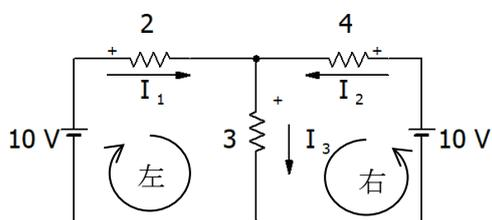
まず左ループでキルヒホッフの第二法則を適用する。わかりやすいように電流の向きによる+の部位を各抵抗に振っている。この+とは実際に定義した方向と逆に電流が流れていた場合、-の電位になるが、これは計算上+というだけである。
