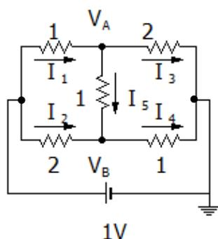
これで接点方程式をたてる。VA点とVB点について、電流のキルヒホッフの第一法則を適用する。
