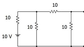
6. 次の回路における開放電圧、内部抵抗を求めよ。またこの端子に負荷抵抗  $R_L$  を付けたときに消費電力が最大になる  $R_L$  の値を求めよ。
