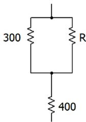
5. 次の抵抗回路の 2 端子間の開放電圧、内部抵抗を求め、たった一つの電圧源と内部抵抗で表される等価回路を描け。一つの抵抗を  $10\Omega$  とする。
