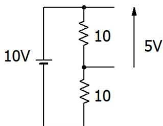
さらに右側の  $10V$  を短絡すると次のようになる。これも図に様書き換えられて、開放電圧は  $5V$  になる。以上のそれぞれの開放電圧をたしわせて、 $10V$  が開放電圧になる。
