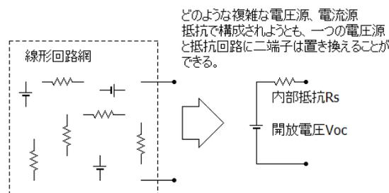
どのような複雑な電圧源、電流源、抵抗で構成されようとも、一つの電圧源と抵抗回路に二端子は置き換えることができる。
