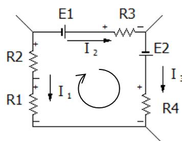
このような回路の閉ループを考える場合は、このやじるし方向に電圧を足し合わせていくと0となるということである。電流の方向が定義されている場合は、抵抗では電流の流れ込む側を+としてくと
