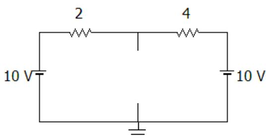
まず開放電圧であるが、2Ωと4Ωの直列抵抗には、両端が10Vで同電位であり、電流は流れないと考える。すなわち、電流0であれば、2Ω、4Ωの電位差（電圧）0であり、開放端の上端は電位として10Vとなる。下端は電位0Vである。したがって開放電圧は10Vとなる。内部抵抗は、10Vの電圧源を両方とも短絡させて求める。
