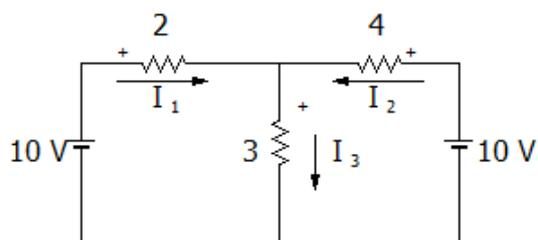
左の 10V と 2Ω、右の 10V と 4Ω はそれぞれ、定電流源と内部抵抗に置き換えることができる。
