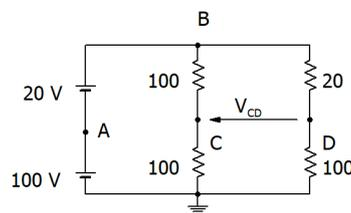
解説) この回路において、アースのマークが電位の基準となるので、アースでつながっている線の全部が電位  $0V$  である。A 点では  $+100V$  の電圧がかけられており、
