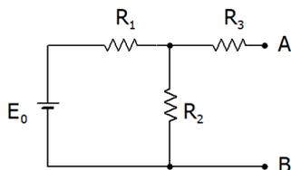
解法) まず二端子の  $V_{oc}$  を求める。 $R_3$  には全く電流が流れていないので、A 点の電位は  $R_1$  と  $R_2$  の接点と同電位になる。この点の電位は、電圧分割の法則から求め、開放電圧  $V_{oc}$  は次のようになる。
