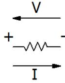
図2 電流の向きと発生する電圧の向き
