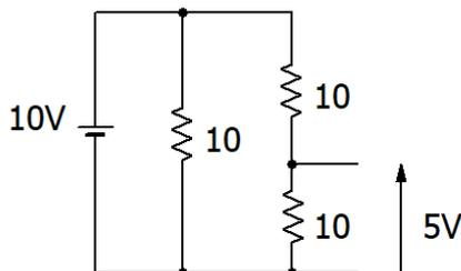
7. この回路は重ね合わせの原理と使って解くと、開放電圧は  $110/3V$ 、内部抵抗は  $20/3\Omega$  となる。
