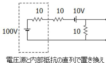
8. まずは  $R$  に流れる電流を求める。例題 9 に示されるように、接点の電位を図のように  $V_A$  と  $V_B$  を決めて、そこに流れ込む電流の総和がゼロとして、次の連立方程式を解く。
