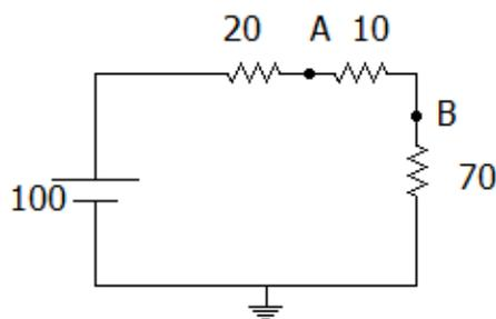
解法) この回路は 20  $\Omega$  と 10  $\Omega$  と 70  $\Omega$  の直列回路である。全直列抵抗は 100  $\Omega$  である。70  $\Omega$  の抵抗に  $100V \times 70/100 = 70V$  の電圧がかかり、B 点の電位は 70V となる。10  $\Omega$  の抵抗には、 $100V \times 10/100 = 10V$  の電圧がかかる。A 点はアース点に対して 70 + 10V の電圧がかかり、A 点の電位は 80V となる。
