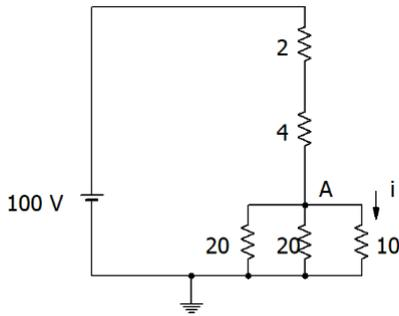
この回路においても、直列回路における電圧分割の法則が使える。20Ω 2個と10Ωの並列抵抗部分は、5Ωの抵抗とみなせる。そこで暗算で全抵抗が、2+4+5で11Ωと計算できる。並列抵抗部分にかかる電圧は100Vの5/11であるので、A点の電位は500/11Vとなる。10Ωに流れる電流*i*は $500/11 \div 10 = 4.55$  Aとなる。ここに示すように、この程度の回路なら、直列回路における電圧分割の法則をつかえば、暗算で計算が可能ということである。
