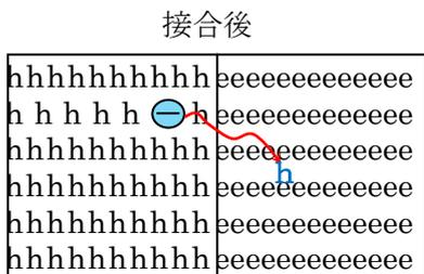
図3 pn接合ダイオードのイメージ理解のための説明図
