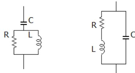
7. 次の回路の複素インピーダンスを求めよ。インピーダンスの大きさが  $20 \Omega$  になるときの L の値を求めよ。ただし角周波数  $\omega$  は  $100 \text{ rad/s}$  とする。
