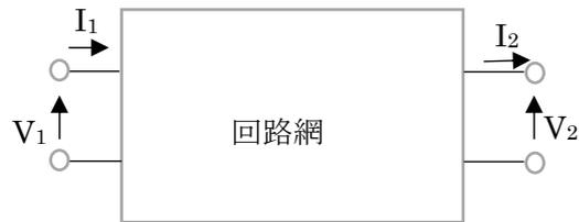
$$\begin{bmatrix} V_1 \\ I_1 \end{bmatrix} = \begin{bmatrix} A & B \\ C & D \end{bmatrix} \begin{bmatrix} V_2 \\ I_2 \end{bmatrix}$$
