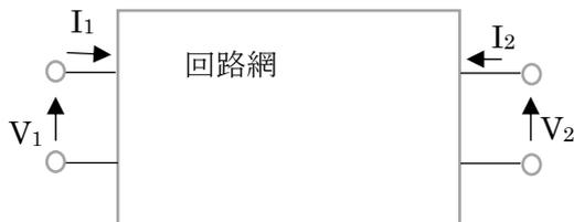
このように  $V_1$ 、 $V_2$ 、 $I_1$ 、 $I_2$  の関係を連立方程式であらわすときに、それをマトリクスで表示することが可能になる。
