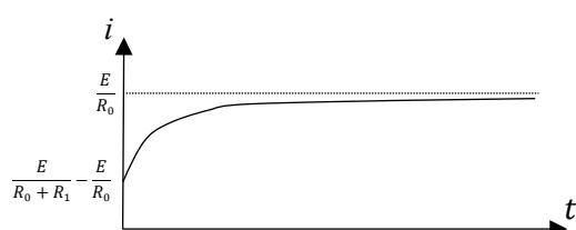
2.  $t=0$  以前では、C は $\infty$ 抵抗の状態であり、 $E[V]$ の電圧がかかっている。これが SW が ON になった場合、 $R_0$  と C の閉路になる。ここを流れる初期電流は、 $E/R_0$  である。なお C の電圧の向きは図の赤字で示す通りである。
