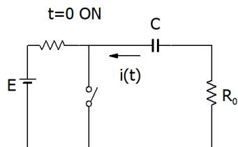
3. 次の回路で  $t = 0$  のときに SW が OFF から ON に変わると、電流  $i(t)$  の波形をもとめなさい。
