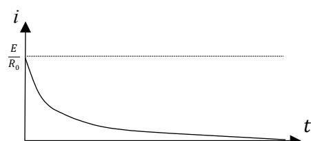
3.  $t=0$  以前は、コイル L に  $E/R[A]$  の電流が流れている。SW がオフになった瞬間コイルがコンデンサにその電流を流そうとする。したがって、 $i(0)$  は  $E/R$  である。
