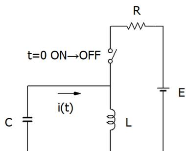
4. 次のような回路において、スイッチがオンさせると、電流に振動波形が現れて、周辺に電磁ノイズが現れることが分かった。電磁ノイズを起こさないためには R をどのような条件に設定すればよいか。
