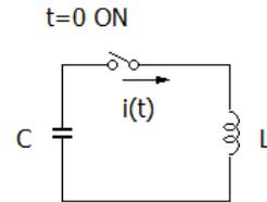
\*コンデンサには $t=0$ の時点で $Q_0$  [C]の電荷があるとします。
