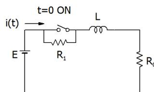
2. 次の回路で  $t=0$  のときに SW が ON となるとして、電流  $i(t)$  の波形をもとめなさい。
