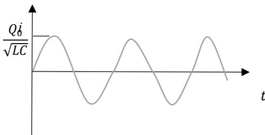
長い計算であったが、慣れれば同じパターンの繰り返しである。技術者としての勘として、L と C が共存する回路では、振動波形は出やすいと覚えておくべきである。強制項が定数の二階微分方程式の
