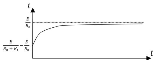
2.  $t=0$  以前では、C は  $\infty$  抵抗の状態であり、 $E[V]$  の電圧がかかっている。これが SW が ON になった場合、 $R_0$  と C の閉路になる。ここを流れる初期電流は、 $E/R_0$  である。なお C の電圧の向きは図の赤字で示す通りである。
