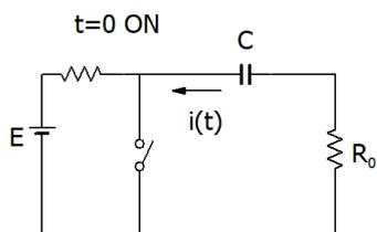
3. 次の回路で  $t=0$  のときに SW が OFF から ON に変わるときに、電流  $i(t)$  の波形をもとめなさい。
