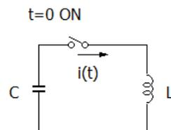
\*コンデンサには $t=0$ の時点で $Q_0$  [C]の電荷があるとします。
