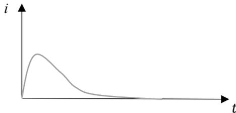
以上、微分方程式で波形が大きく変わることが分かった。判別式が正の場合は減衰、負の場合は振動減衰、そして判別式が0の場合も減衰となるが、正の場合に比べて減衰は速い。判別式が0のときを**臨界制動**いう。臨界制動は単純に、振動するかどうかの分岐点であるだけではなく、速やかに終値に収束する条件といえる。
