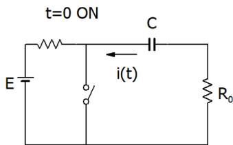
3. 次の回路で  $t=0$  のときに SW が OFF から ON に変わるときに、電流  $i(t)$  の波形をもとめなさい。
