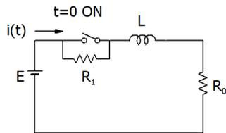
2. 次の回路で  $t=0$  のときに SW が ON となるとして、電流  $i(t)$  の波形をもとめなさい。
