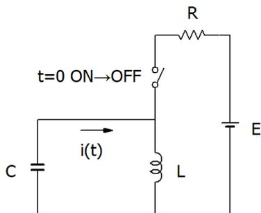
4. 次のような回路において、スイッチがオンさせると、電流に振動波形が現れて、周辺に電磁ノイズが現れることが分かった。電磁ノイズを起こさないた
