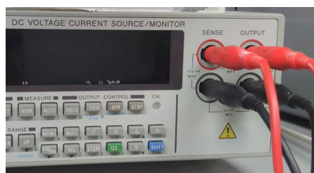
図5 市販の電圧電流測定ユニットの例 SENSE とあるのが電圧計測端子、OUTPUT とあるのが電流出力端子になる。
