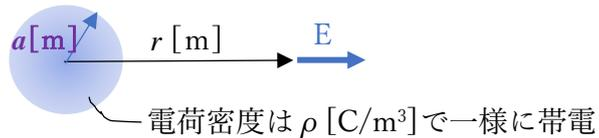
球状電荷の場合は、閉曲面として球の中心から半径  $r$  の球面を考える。
