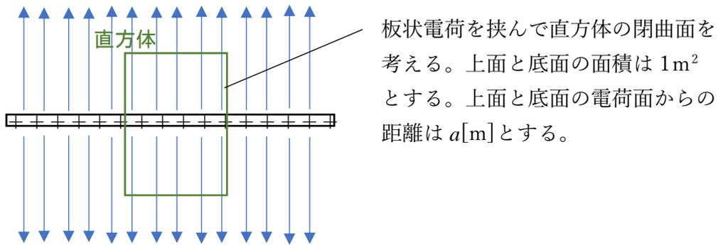
板状電荷を挟んで直方体の閉曲面を考える。上面と底面の面積は  $1\text{m}^2$  とする。上面と底面の電荷面からの距離は  $a$  [m] とする。
