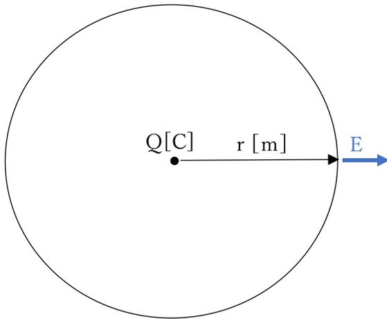
このような点電荷や球状電荷の場合は、閉曲面として点電荷を中心とした半径  $r$  の球面を考える。ガウスの式の左項は、電界の閉曲面の面積分であり、電界  $\mathbf{E}$  と閉曲面は直交しており、しかも閉曲面のどこでも電界の強さは同じであることから、閉曲面の面積  $\times$  電界の強さ  $E$  で表される。つまり、左項は  $4\pi r^2 E$  となる。 $E$  はベクトルではなく、電界の強さである。
