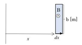
微小距離 dx と長さ b でできる長方形の面積は b dx であり、この範囲で B が一定であるとすることができ、そこを通る微小磁束密度  $d\Phi$  は、b B(x) dx となる。したがって、鎖交磁束は  $d\Phi$  を距離 L から L+a まで積分することで求められる。
