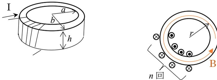
これはトロイダルコイルの中心からの距離を  $r$  とする。トロイダル内の透磁率が十分に大きい場合、磁束線はトロイダル内を輪となって閉じ込められる。アンペールの式より、
