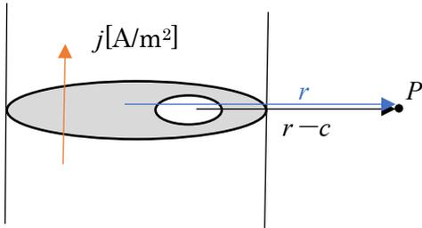
一見すると難しそうだが、孔の部分には  $-j[\text{A/m}^2]$  の電流が流れていると考え、孔のない円筒の  $j[\text{A/m}^2]$  の電流と孔の部分  $-j[\text{A/m}^2]$  の電流が重ね合わされていると考える。
