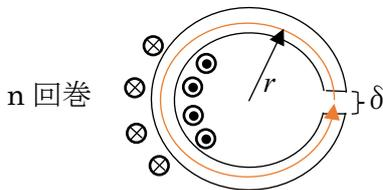
トロイダルの中心から半径  $r$  の円環をアンペールの積分経路とする。この経路内部での磁束密度は等しいが、透磁率がギャップ間と磁性体で、違うので、アンペールの式は  $H$  を使って解く。
