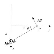
xz 平面全体にわたる微小区間に作る電流による磁東密度を積分すると、最終的には磁東密度は-x 方向しか残らない。P 点の磁東密度の-x 方向成分を  $B_{-x}$  とすると、
