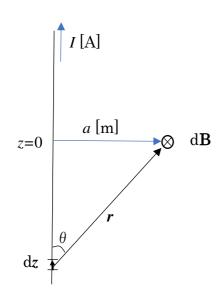
z 軸上に電線があるとして、左図のような構成を考える。微小要素 dz の電流が半径 a [m]の位置に作る磁束密度を dB とする。ビオサバールの式を用いると次のようになる。
