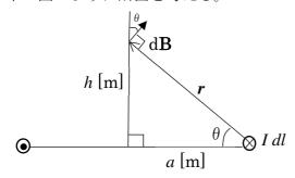
図のように微小電流 Idl が作る磁束密度 dB は位置ベクトルr に対して、直角の 方向に向いている。なお位置ベクトルr と電流の方向は直交しているため
