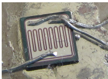
図 13 実際のバイポーラトランジスタの楕形電極構造 AI のワイヤーが 1 本の方がベース電極、2 本で接続されている方がエミッタ電極になる。
