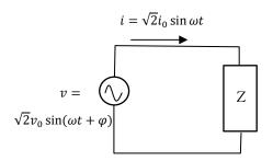
正弦波は大きさと位相角のベクトルで 表示でき、電圧と電流のベクトルはこの ようになる。
