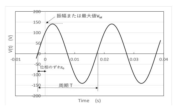
通常、電気回路の世界では、交流の電圧の表示は実効値を使う。100V といえば、最大値は $\sqrt{2}$ 倍の約 141V が出ている。交流電圧  $v_0[V]$ という場合は、実際の交流の最大値は $\sqrt{2}v_0$  ということである。ただし、このルールが適用されていない場合もあることはある。この教科書では、交流信号の値表示は、電圧、電流を問わず実効値とする。
