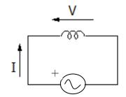
ここで、コンデンサに交流電圧をかけたときの、電力を計算してみる。 $I = I_0 sin\omega t$ 、さらに $V = \omega LI_0 cos\omega t$ として、一周期分の平均電力を計算する。
