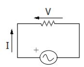
ここで、実効値  $V_E$  の交流電圧 ( $V=\sqrt{2}V_E sin\omega t$ ) が抵抗  $R[\Omega]$ にかけられているときの消費電力を求めてみよう。電力の瞬時値は時々刻々と変化しているので、一周期の平均でもとめてみる。
