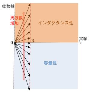
このベクトル図を 2 次元座標で、横軸を実軸、縦軸を虚数軸とよぶ。周波数が非常に低いときは、 $\omega L - \frac{1}{\omega c} < 0$ となり容量性となる。位相角は $-\pi/2$ から周波数が増加すると角度が低くなり、水平位置で共振条件となる。このときインピーダンスのベクトルの長さは最小の Rとなる。さらに周波数が上がると、インダクタンス
