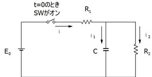
4. 次の回路の電流  $I$  をラプラス変換した形で求め、波形が  $R_1$ 、 $R_2$ 、 $C$ 、 $L$  によってどのような形になるのか示しなさい。ただしコンデンサの  $t=0$  のときの電荷はゼロとする。
