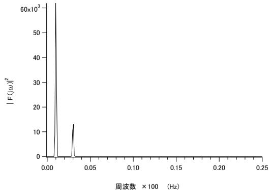
信号波形は 1Hz と 3Hz の成分から成り立っていることが分かる。このグラフはエネルギー密度スペクトルであり、エネルギー密度は振幅の 2乗に比例するため、信号波形は 1Hz と 3Hz の成分は 4 : 1 になるはずだが、計算されたフーリエ変換後のピークはそれとは若干ずれがあるようと思える。これは実際に DFT 計算を行う上で、元関数の始点と終点をゼロにするため、窓関数をかけて処理を行うが、その処理の影響でずれが生じる。非常に長くサンプリングを行い、データ点数を増やしていくことで、そのずれは小さくなる。
