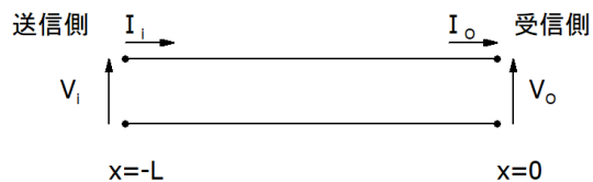
図3 長さ l の伝送線路の従属行列を考える。
