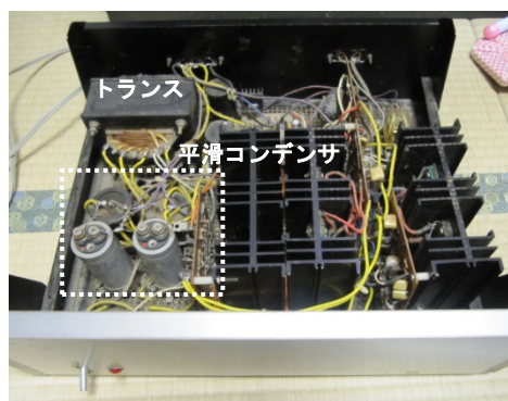
図 2 筆者自作の A 級 20W ステレオアンプ トランスとコンデンサの占める重さは大変大きい。
