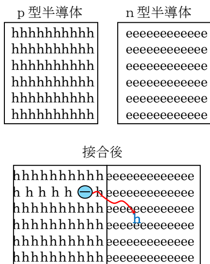
図3 pn接合ダイオードのイメージ理解のための説明図
