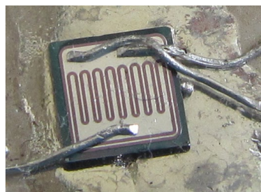
図 13 実際のバイポーラトランジスタの楕形電極構造 Al のワイヤーが 1 本の方がベース電極、2 本で接続されている方がエミッタ電極になる。
